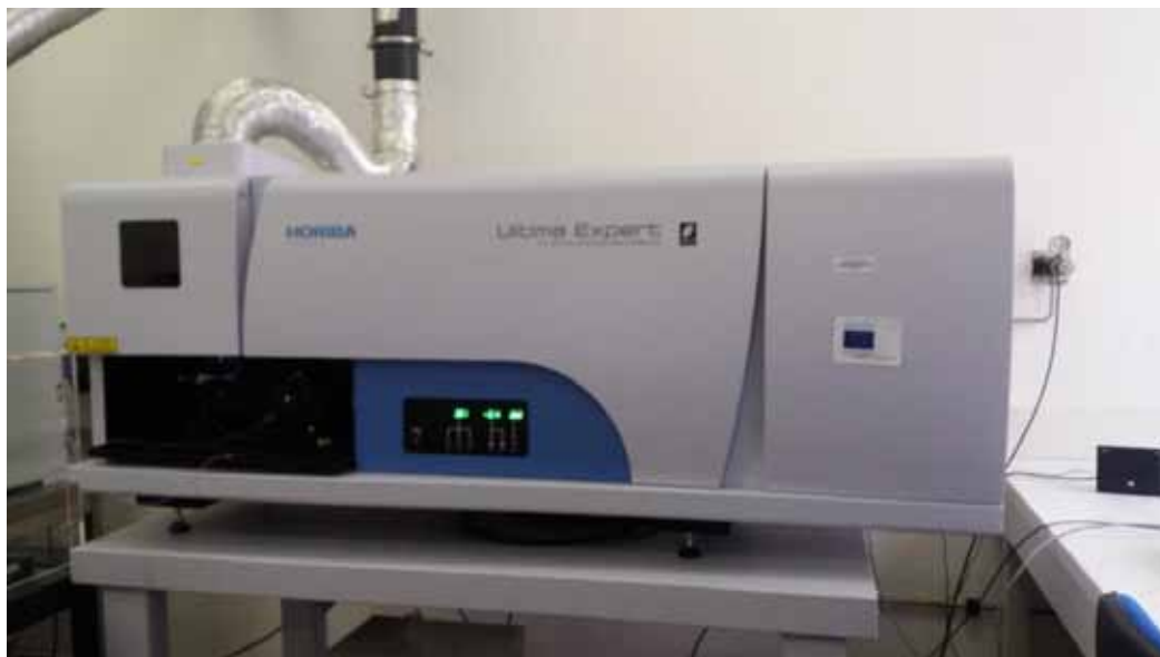
Figure 136 - La machine d'analyse de type ICP-OES au laboratoire Archéosciences
