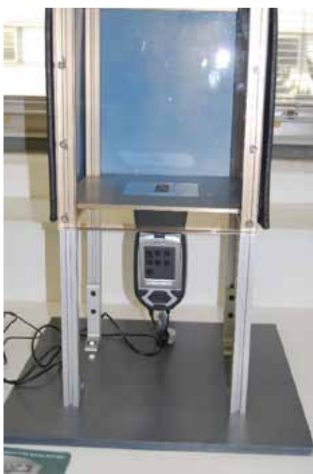
Figure 137 : Dispositif d'analyse par fluorescence X portable. Appareil monté sur son support plombé
