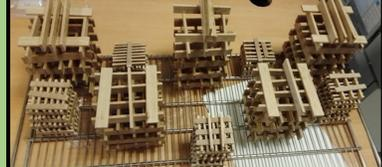
Barreaux réalisés au Japon dans les directions L et R du bois pour essais de retrait/gonflement et mesures statique et vibratoire des propriétés mécaniques.
