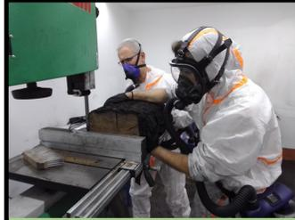
Le bois ancien est au préalable purgé des parties polluées au plomb. Le bois contemporain est extrait de poutres testées au LGC2D d'Egletons pour la nouvelle charpente. Chacun fournit deux types d'échantillons en fonction du test.
