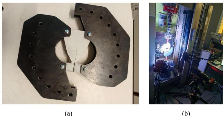
Fig. 2 : (a) Système Arcan ; (b) Dispositif expérimental
