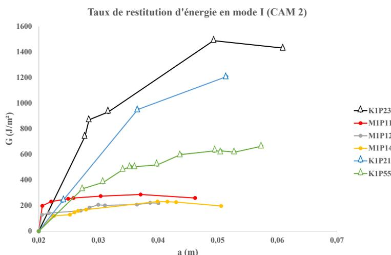
Fig. 3 : Taux de restitution d'énergie en fonction de l'avancée de fissure
