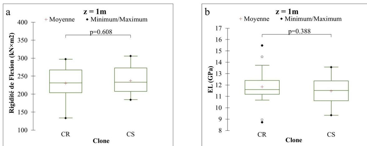
Fig. 3 : Variation de la rigidité de flexion ( $E_L J$ ) des arbres des clones IRCA41 et IRCA825. **b.** Variation du module d'élasticité longitudinal ( $E_L$ ) des arbres des deux clones. Les valeurs de ces paramètres ont été calculées à  $z = 1 \text{ m}$ , à partir des données de déformation mesurées lors des tests de flexion. CR = clone résistant et CS = clone sensible
