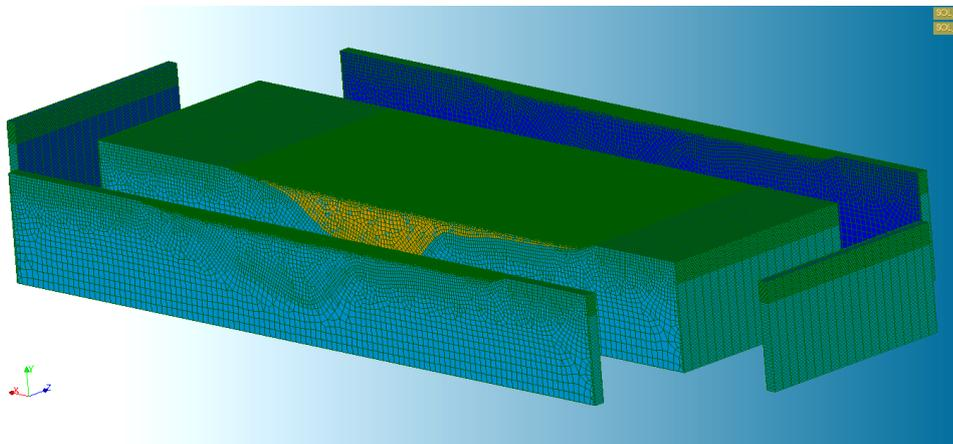
**Figure 1 - Vision schématique des modèles auxiliaires pour l'obtention des conditions aux limites**
