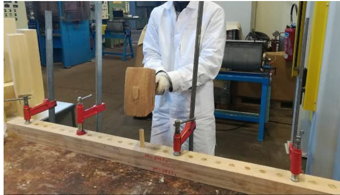
Figure 3 – Assemblage de poutres bois multicouches par tourillons
