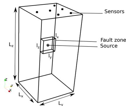
FIGURE 1 – Géométrie du modèle numérique
