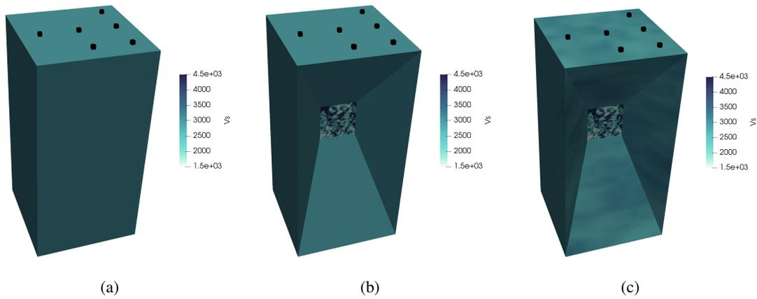
FIGURE 3 – (a) Modèle homogène (b) Modèle hétérogène de la zone de faille enveloppé dans un modèle homogène de croûte (c) Modèle hétérogène de la zone de faille et de la croûte
