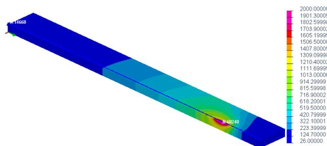
FIGURE 3 – État thermique stationnaire (températures en degré)
