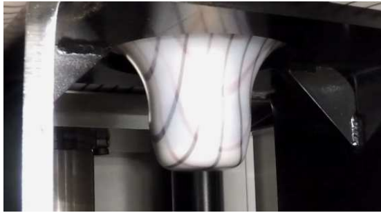
Figure 1 – Montage expérimental et modèle numérique de l'essai de poinçonnement.
