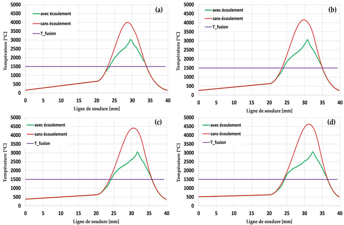
FIGURE 8 – Effet d'écoulement du fluide sur l'évolution de la température le long de la ligne de soudure : (a)  $t = 0,6 s$ ; (b)  $t = 0,8 s$ ; (c)  $t = 0,7 s$ ; (d)  $t = 0,8 s$ .
