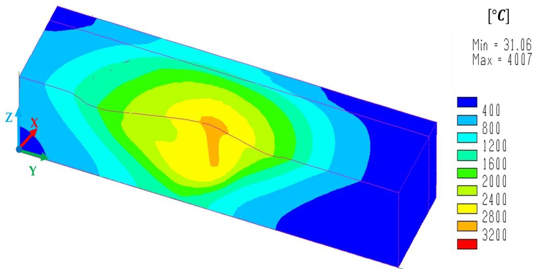
FIGURE 2 – Distribution de la température à  $t = 0,55 s$  sur le maillage déformé sous l'effet de la surface libre.
