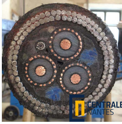
FIGURE 1 – Photographie d'une section de câble de transport d'énergie (soucre ECN).
