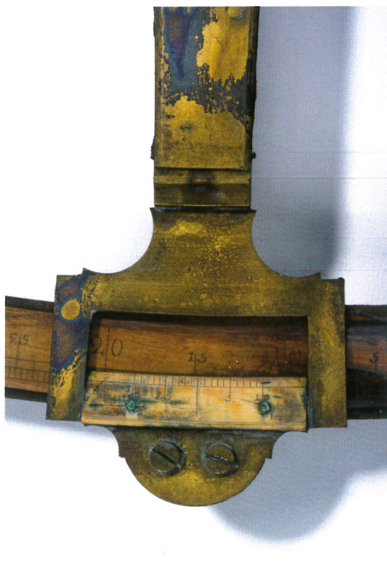
Planche 4 : Vues de détail de l'octant (26192). © Images Explorations.
