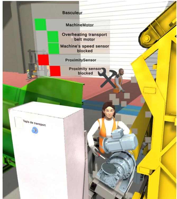
**Figure 4: Le compagnon numérique démontre le diagnostic de détection de panne ainsi que la procédure de réparation du moteur défectueux.**
