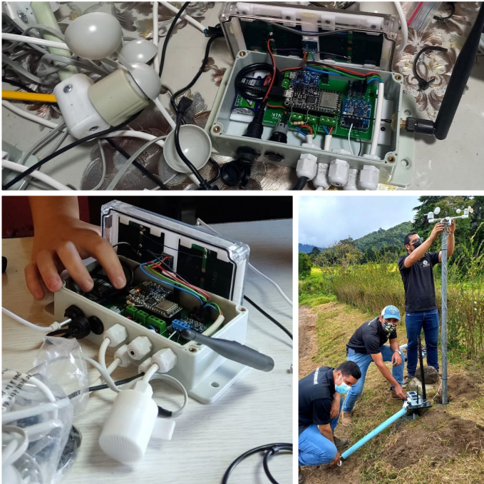
Figura 22. Redes inalámbricas de sensores ambientales del proyecto Smart-Agrip en Panamá (FIED-2019-R1-003).
