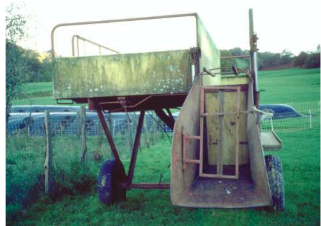
Photo 20 : La baignoire mobile de Sauguis est encore utilisée. On voit ici le monte charge permettant de hisser la bête jusqu'au bain. Quelques rares éleveurs déplorent des accidents pendant cette opération.
