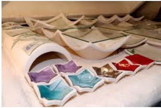
صورة رقم 3 : تقنية التشكيل الحراري: قطع بلورية أثناء وضعها في فرن الانصهار
