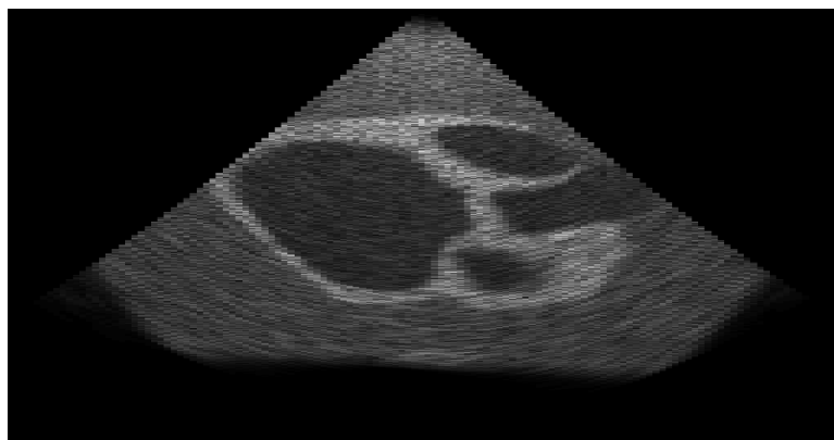
Figure 9: Simulation échocardiographique obtenue avec le logiciel FIELD-II.
