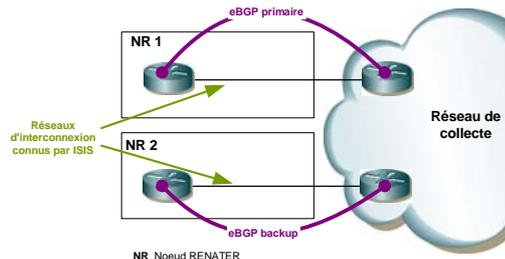
Figure 5 – mode de raccordement sur un NR (mode 2)
