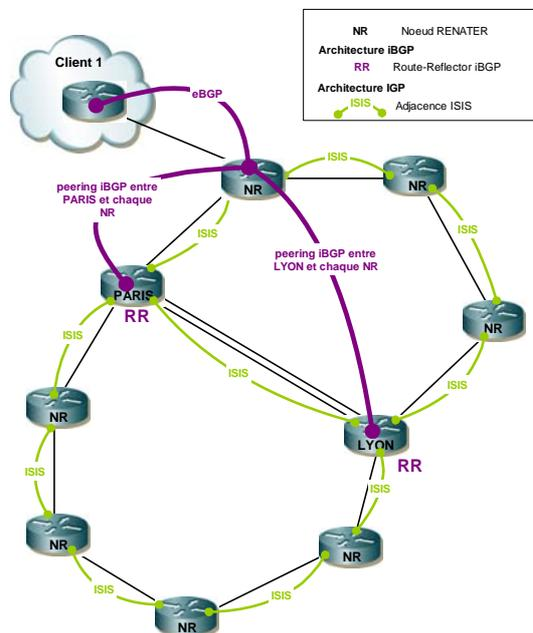
Figure 1 – Topologie de l'IGP et de l'EGP sur le backbone RENATER
