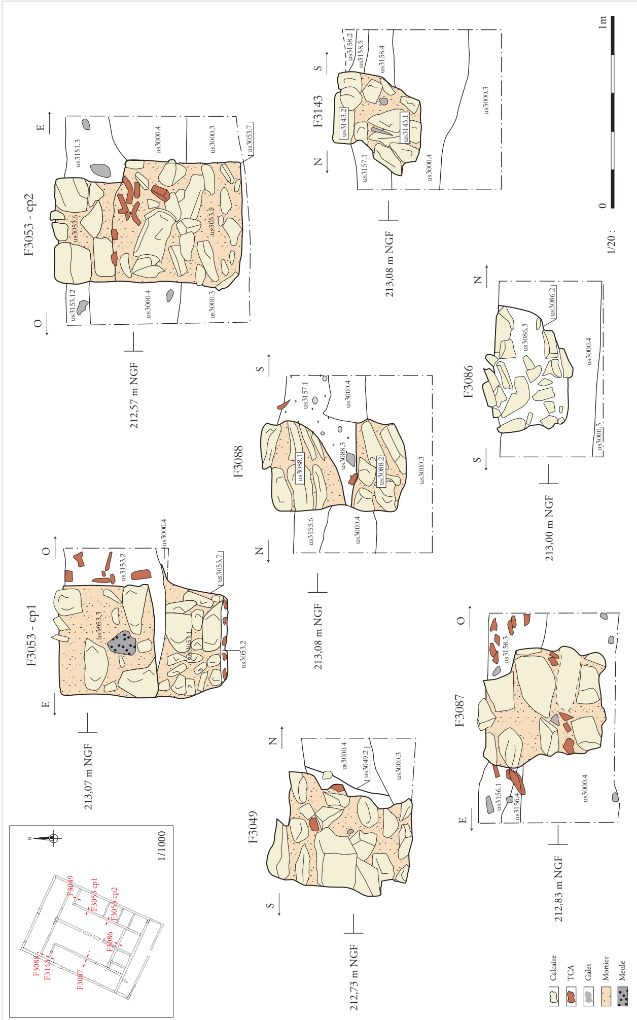
Fig. 37 : Coupes des murs de refend du bâtiment ENS3001-état 1, éch. 1/20 (DAO : J. Javelle - J. Grasso).
