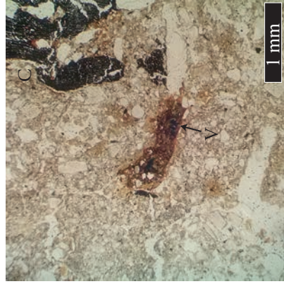
3 : Cristal de vivianite (V) dans un agrégat argileux et charbon (C), LPNA.
