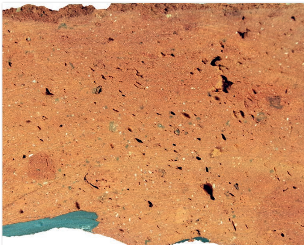
ill. 219 : Pâte des tuiles de type E.
