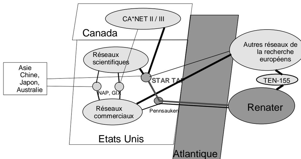
Cette liaison assure la connectivité à haut débit avec l'ensemble des réseaux de la recherche et des réseaux commerciaux des Etats Unis. Par transit à travers ceux-ci, elle permet aussi de rejoindre les réseaux d'autres pays : Canada, Asie et Pacifique etc.
