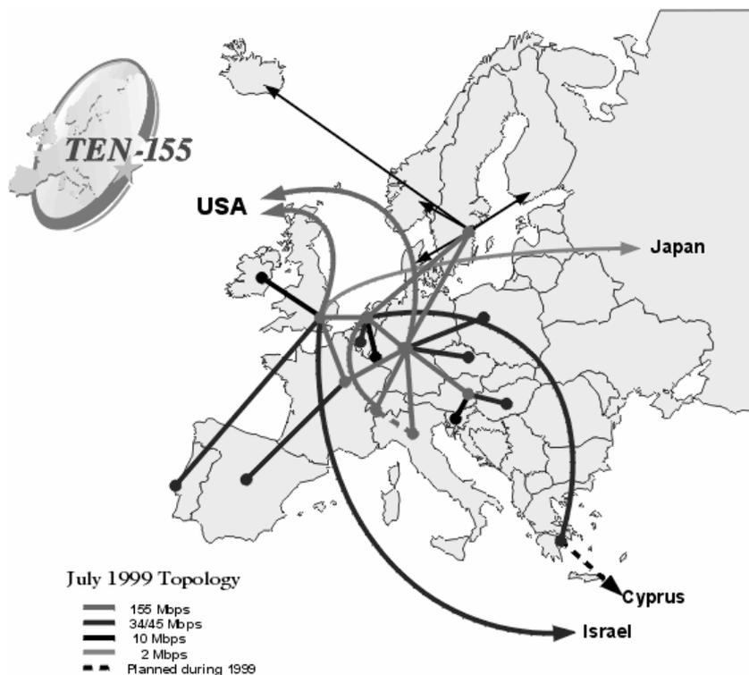
TEN-155 interconnecte à haut débit (jusqu'à 155 Mbit/s) les réseaux européens en IP et B pour des besoins spécifiques à la demande B en ATM. En particulier, il offre un service de gestion de bande passante et de qualité de service : le MBS (Managed Bandwidth Service) permet d'attribuer, sur TEN-155, entre des nœuds du réseau spécifiés, à un projet bien identifié, une bande passante garantie avec les paramètres adéquats de qualité de service.
