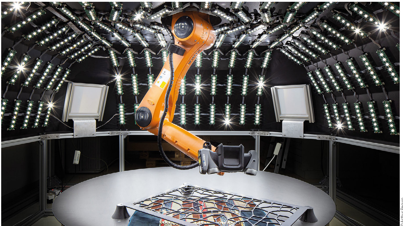
La Coupole, système opto-numérique d'acquisition de l'apparence des objets développée par le laboratoire MANAO/INRIA de Bordeaux.
