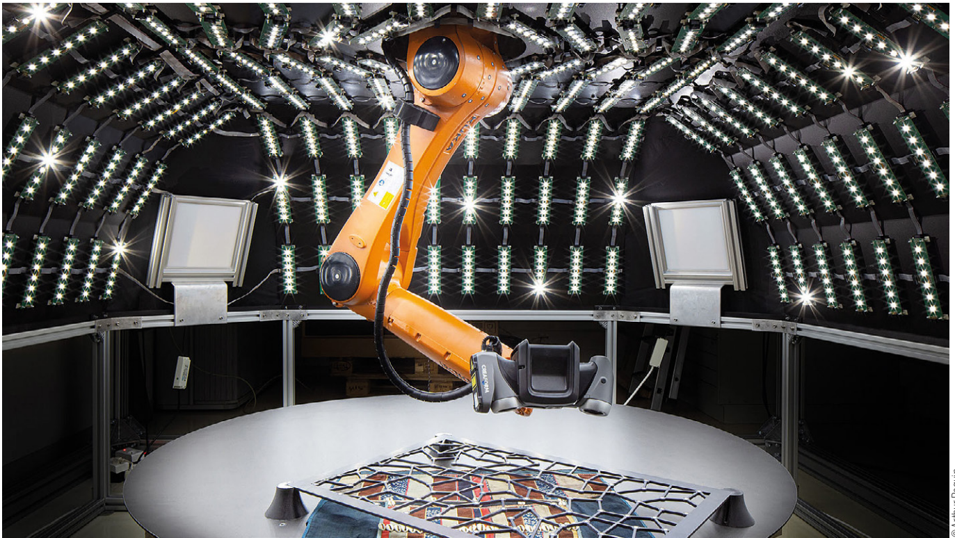
La Coupole, système opto-numérique d'acquisition de l'apparence des objets développée par le laboratoire MANAO/INRIA de Bordeaux.
