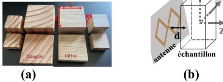
Figure 3 : (a) Données géométriques des échantillons. (b) Repère des plans de coupe et distance  $d$  de la surface de l'échantillon au centre de l'antenne
