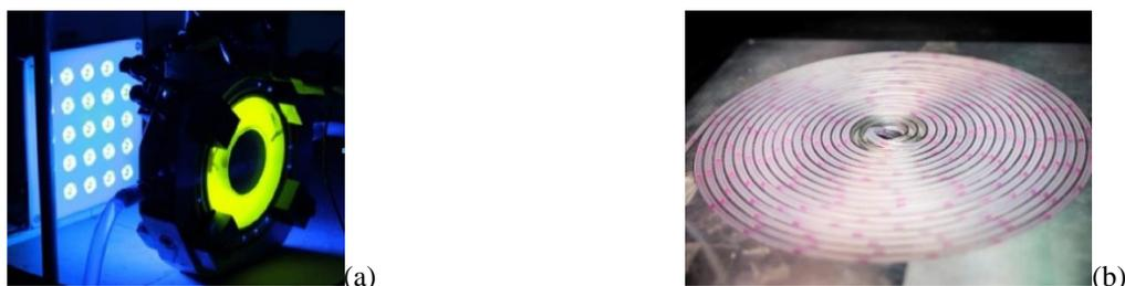
Fig. 1. (a) Photoréacteur de référence avec conditions hydrodynamiques parfaitement maîtrisées (Dahi et al., 2015) et (b) réacteur microfluidique en continu de forme spiralée (Radjagobalou et al, 2018).
