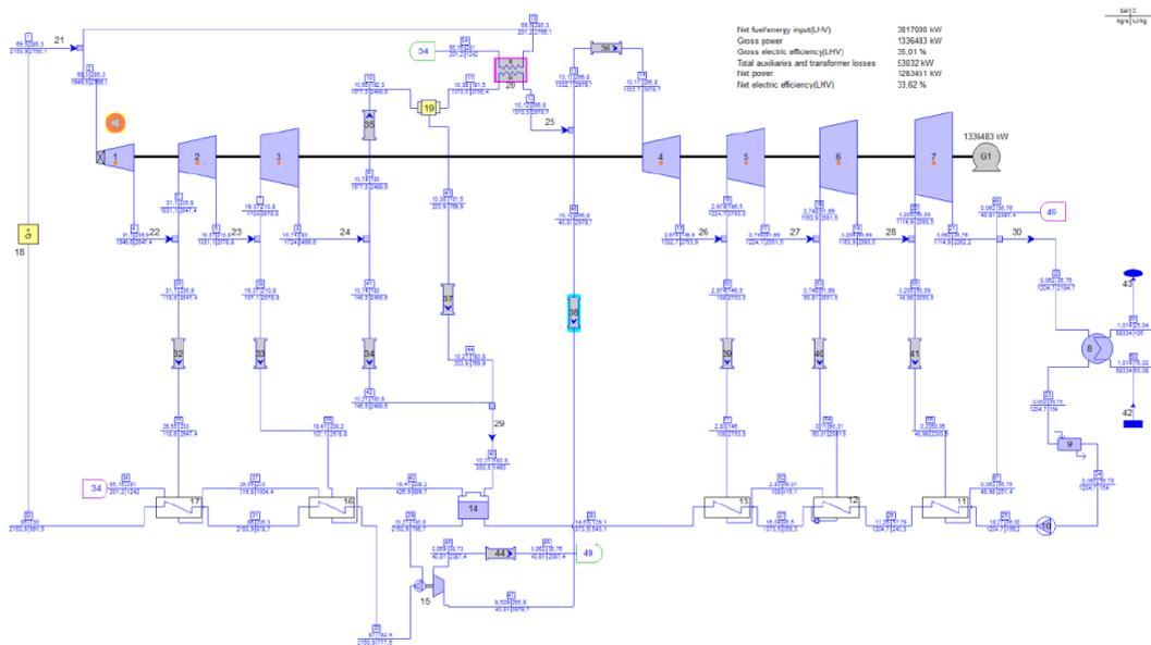
FIGURE 2. Modèle THERMOFLEX d'un REP 1300 MWe [4].
