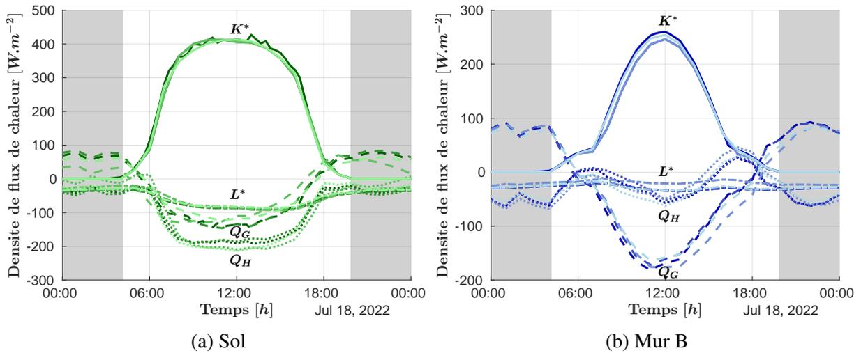
Figure 5 : Flux solaire net  $K^*$ , infrarouge net  $L^*$ , conductif  $Q_G$  et convectif  $Q_H$  sur le sol et le mur B. La légende couleur pour les différents modèles est identique à celle de la Figure 4.
