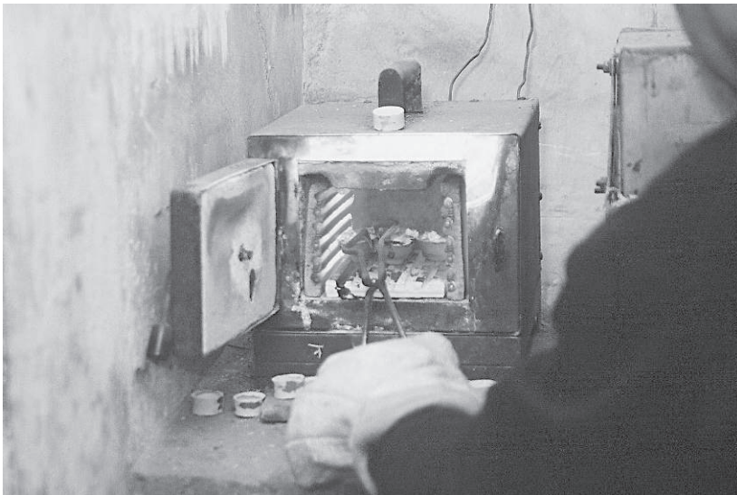
Fig. 4. – Essayeur de Potosí devant un four électrique contenant des scorificateurs
