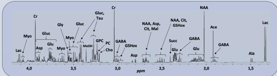
Région (1,3-4,2 ppm) d'un spectre RMN <sup>1</sup>H enregistré sur un spectromètre Bruker 500 à 25°C de la phase aqueuse d'un échantillon contrôlé
