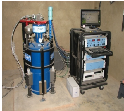
Gravimètre SG-060 installé à Djougou (Bénin) et réseau mondial GGP (Global Geodynamics Project).
