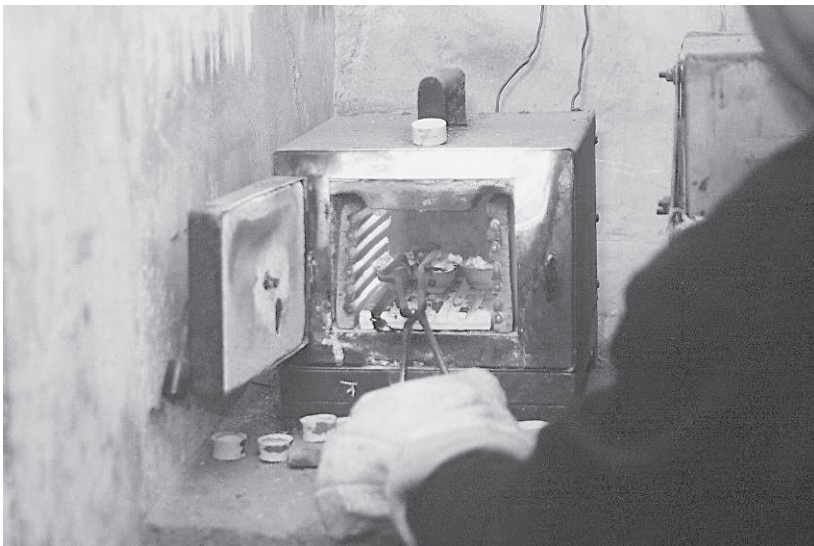
Fig. 4. – Essayeur de Potosí devant un four électrique contenant des scorificatoires
