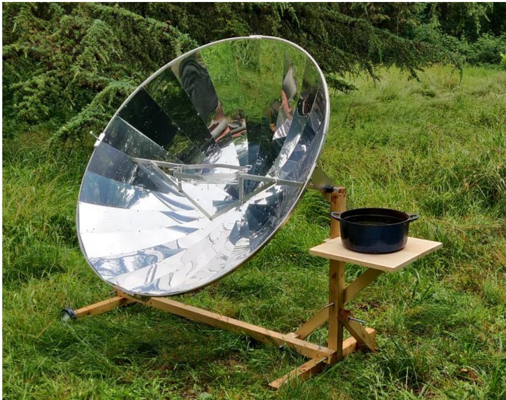
Figure 1: Parabole de cuisson solaire en aluminium et structure bois
