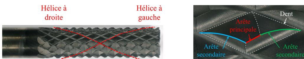
Figure 3 : fraise multi-dents à taille diamant et détail d'une dent
