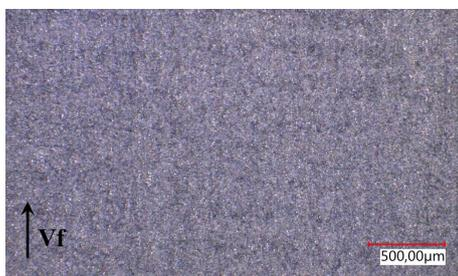
Figure 9 : surface usinée à  $\Psi = 135^\circ$
