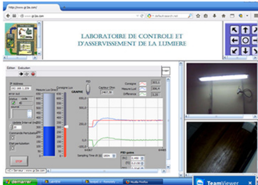
Figure 2 : Échantillon de résultats d'essais par un téléopérateur Internet localisé en France, du laboratoire réel d'automatique installé à l'ENSET de Douala.
