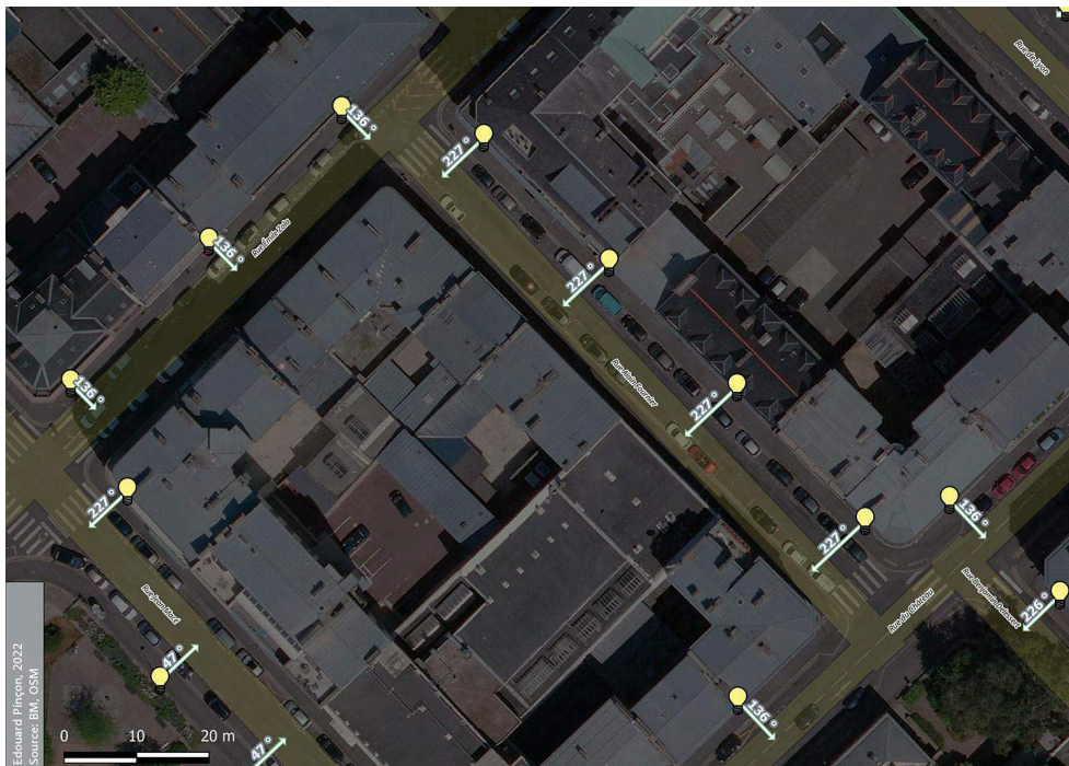
Figure 5 : projection des données ponctuelles sur les voiries et détermination de l'azimut
