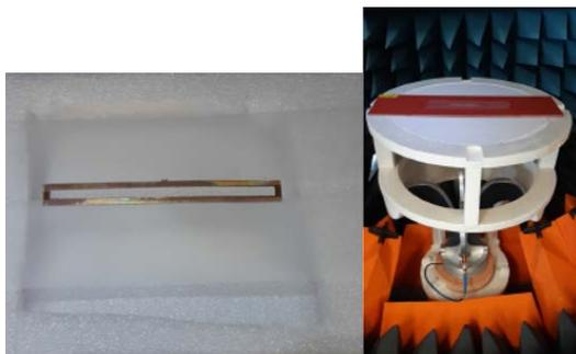
Figure 4. Banc d'essai utilisé pour les mesures. (a) Mesure initiale pour évaluer  $(\sigma_0, \omega_0)$ . (b) Mesure d'un échantillon planaire.
