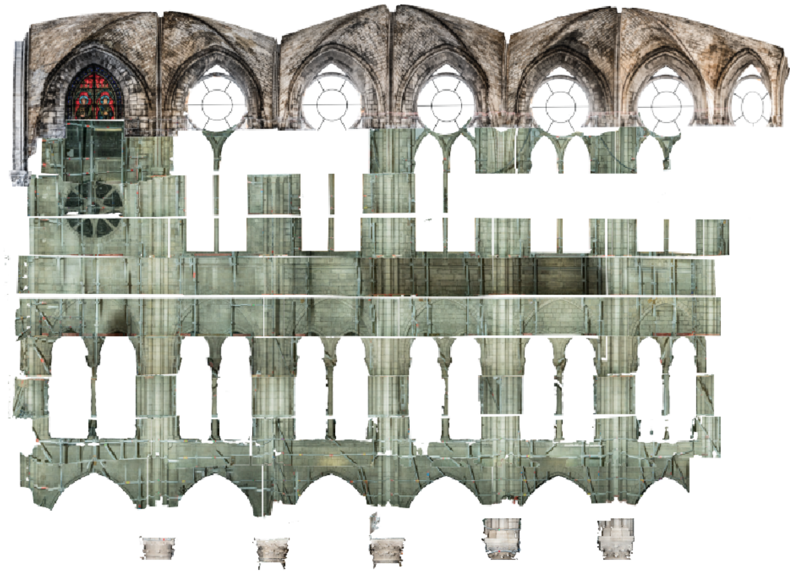
Numérisation photogrammétrique sur échaffaudage Lumière frontale avec un Ultra Grand Angle rectilinéaire 10m
