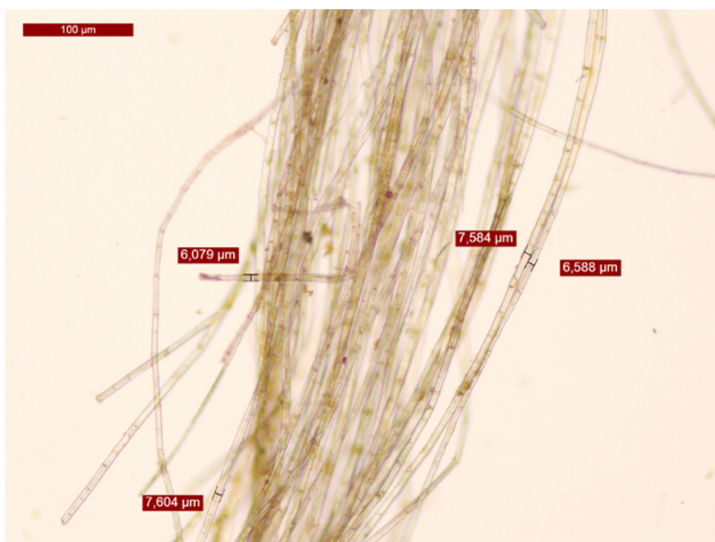
Figure 2 Vue longitudinale au microscope optique de fibres de lin appartenant à l'épave LSG4, calfat 54-7-8. © Laure Meunier.
