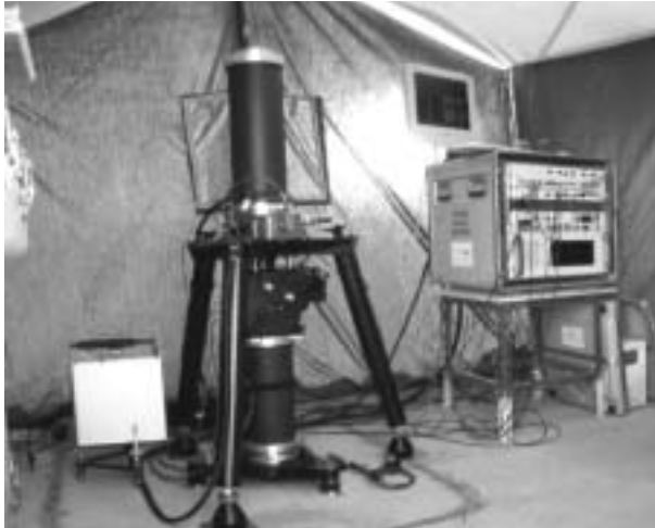
Fig. 7a : Gravimètre absolu FG5 (206) en fonctionnement autonome dans une zone désertique au nord Chili (2002)
