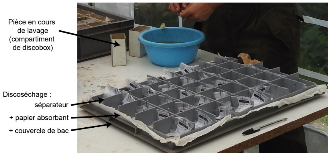
891 Fig. 8 - Composition des plateaux compartimentés de séchage ("discoséchage").
