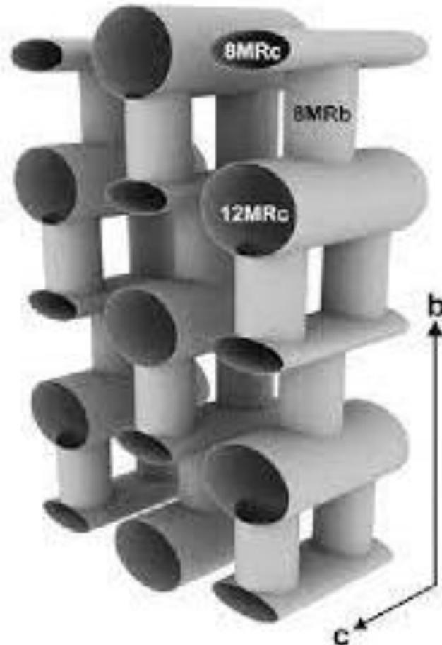
Système de de canaux dans la mordénite accessible pour la diffusion de cations et de molécules
