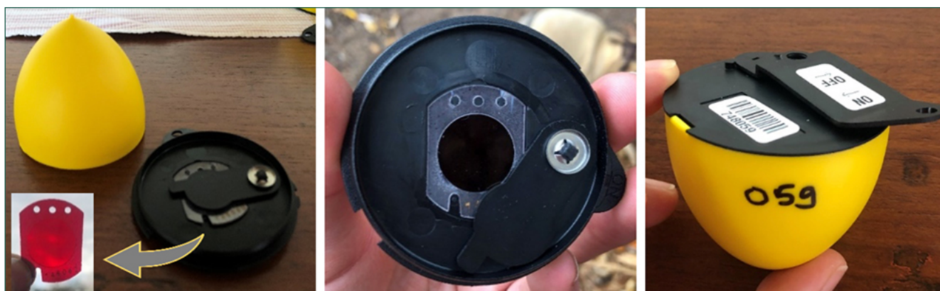
Figura 1. Dosímetros pasivos. De izquierda a derecha: Interior del contenedor cerrado y película LR-115, base del contenedor abierto con película, contenedor y pestaña exterior. (Fuente propia)
