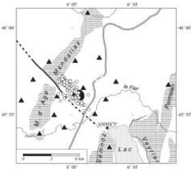
Fig. n°8 : Carte du réseau temporaire et des 174 répliques du séisme d'Épagny les mieux localisées ( \pm 0,3 km). Le choc principal est indiqué par un gros rond noir. La faille du Vuache est indiquée en trait gras. Texture de briques comme dans la Figure n°7.
