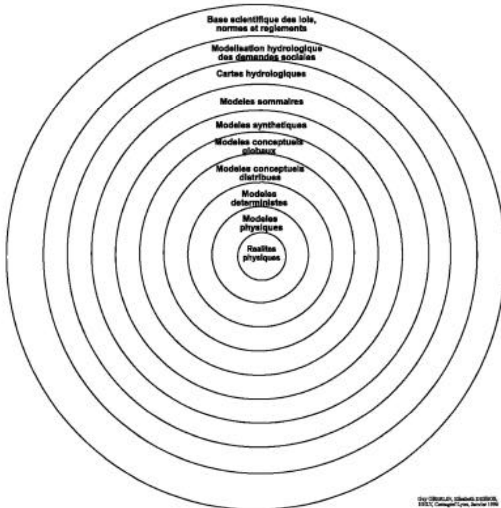
Fig. n°1 : Les différents niveaux de modélisations en hydrologie, en allant de l'analyse à la synthèse, autorisant des validations d'un niveau à l'autre, qu'ils soient ou non contigus.
