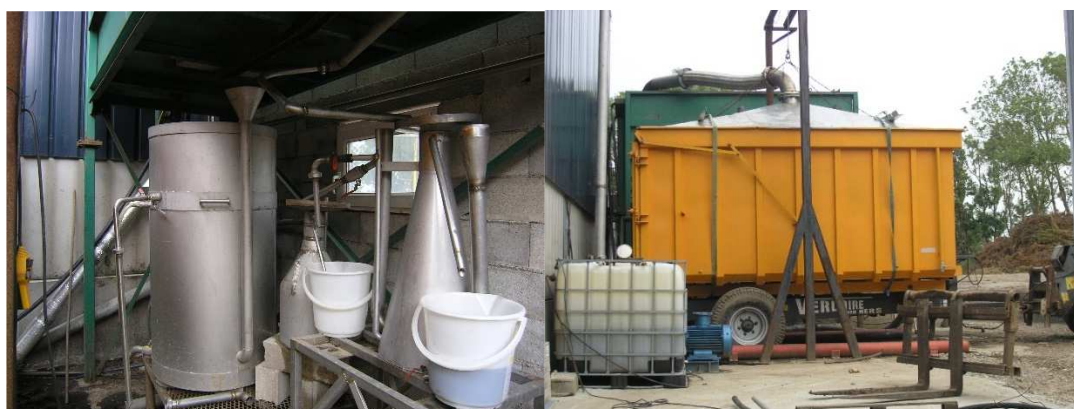
Figure 7 : Pilote d'extraction des huiles essentielles ; à gauche le réfrigérant et l'essencier pour récupérer les HE, à droite la remorque permettant la distillation de la biomasse.
