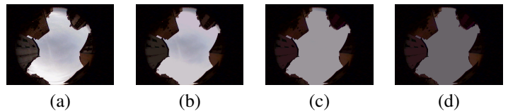
FIGURE 2 – Reconstruction géodésique en fonction du paramètre de contraste H : (a) image originale, (b) RGD avec H = 50 , (c) avec H = 100 et (d) avec H = 150 .
