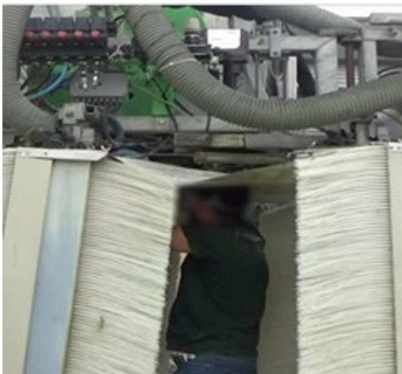
Figure 3 : Réparation des bâches lors d'un épandage amenant l'agriculteur à circuler entre les balais.
