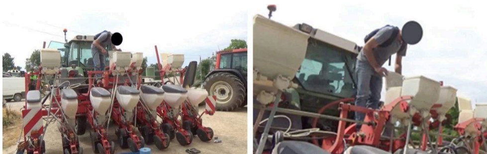
Figure 5 : Nettoyage du semoir à l'aide d'une soufflette par l'agriculteur, source de risques. Figure 5: Farmer's use of a blower to clean the seed drill is a source of risks
