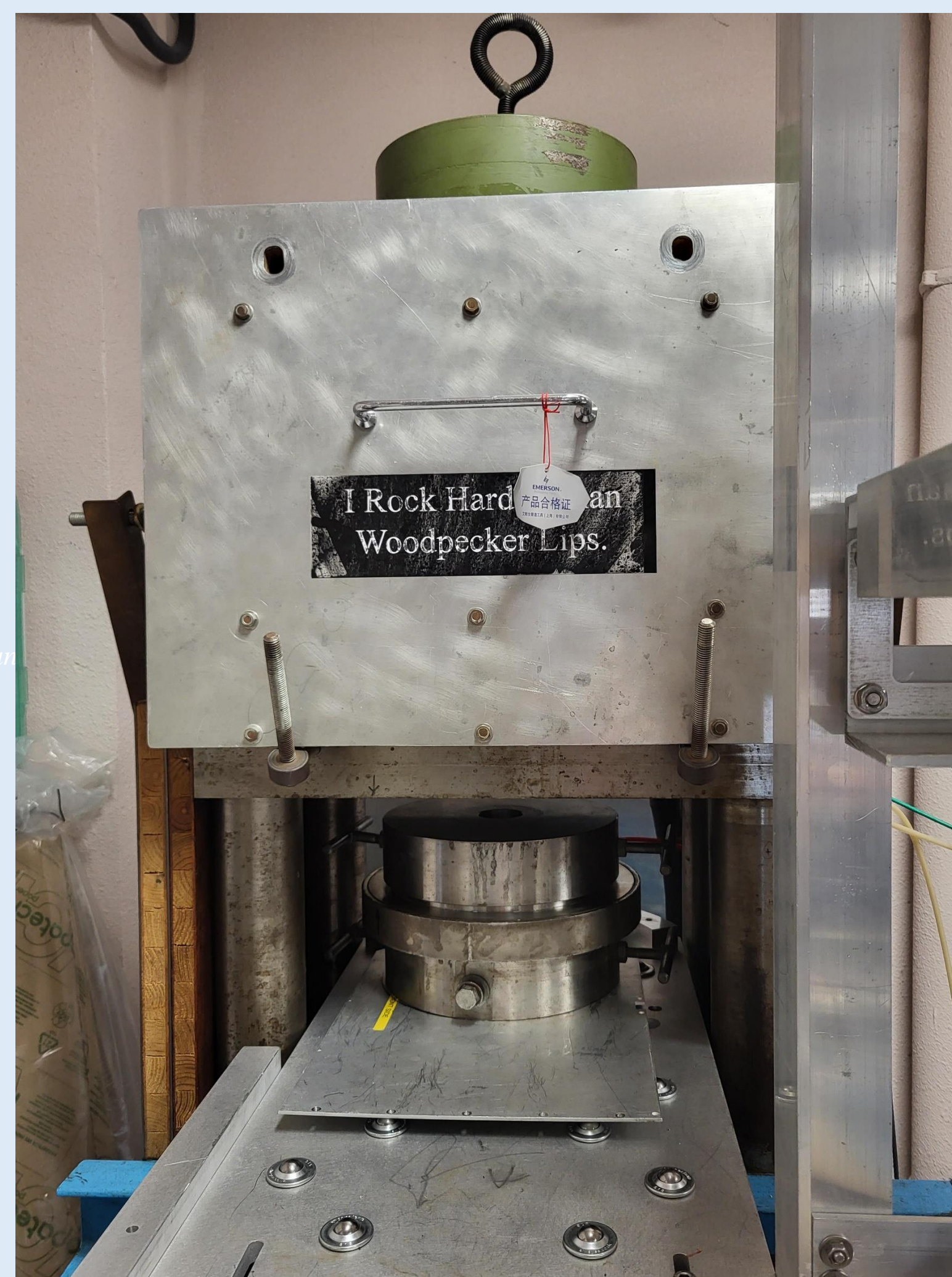
Figure 2. Photos du presse et des pièces pour l'assemblage pour la nouvelle frette du piston cylindre à l'IRAP et d'expérience à 1200°C.
