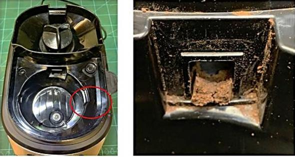
Pour éviter un colmatage de la machine espresso par du café, il est impératif de procéder à un nettoyage complet du broyeur après chaque utilisation.
