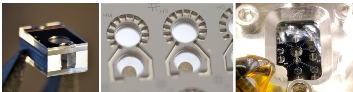
Figure 1 : Exemples de cellules à vapeur alcaline microfabriquées : (a) Vue en coupe d'une vanne fermante consistant en une membrane de verre défléchie par laser sur un canal microfabriqué, (b) Wafer de cellules à réservoirs de gaz tampon entourant la cavité optique (c) Grappe de cellules positionnée sur un banc de remplissage externe avant le scellement laser.
