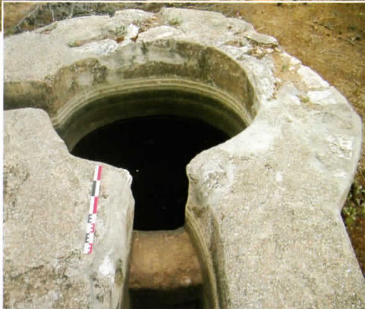
Vestiges de la laverie plane de Soureza, au Laurion. Ici, caisse de débouage.
